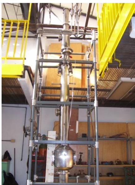
Figura 3 Diseño conceptual de la columna de destilación reactiva de pared divisoria.
