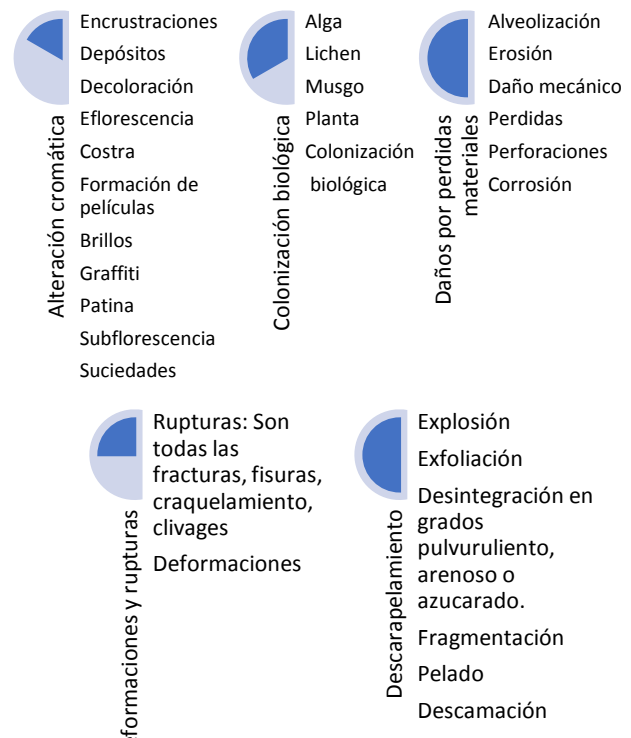
Figura 2 Tipos de alteraciones en la roca
