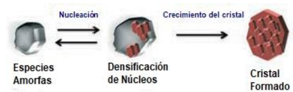
Figura 1: Gráfico que muestra las etapas de nucleación y crecimiento de las zeolitas. Tomada y adaptada de Odriozola (2010).
