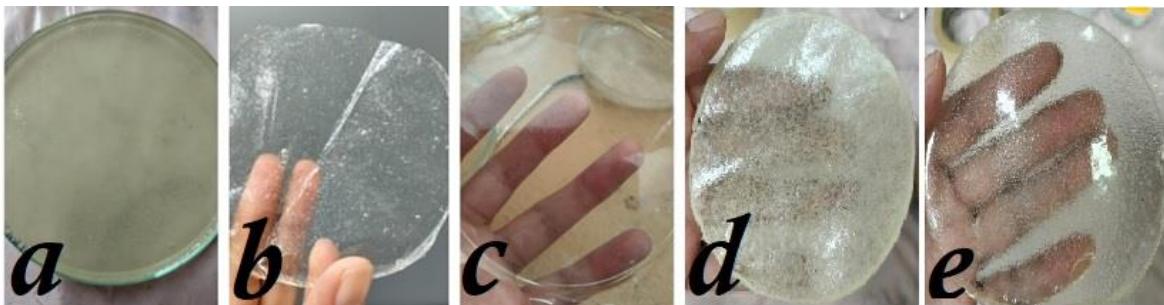
Figura 3. Comparativa visual de las biopelículas de derivados de CST resultantes. a) biopelícula de CST puro húmeda, b) biopelícula de CTS seca, c) biopelícula de injerto de CTS/GMA, d) biopelícula de injerto de CTS/AAM, e) biopelícula de injerto de CTS/GMA/AAM
