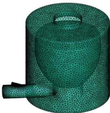
**Figura 2.** Modelo del horno mallado.
