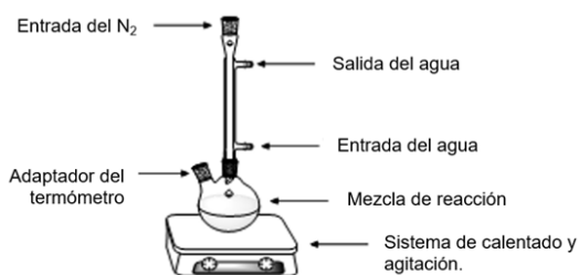
Figura 4. Esquema experimental para la producción de biodiésel.
