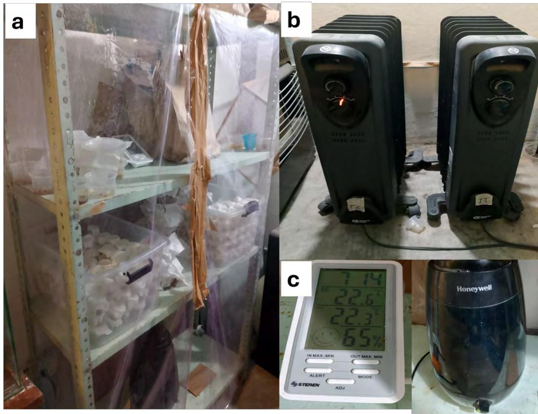
**Figura 2.** Anaquel para mantenimiento de cría de laboratorio (a), Calefactores (b), termohigrómetro digital y humidificador (c).
