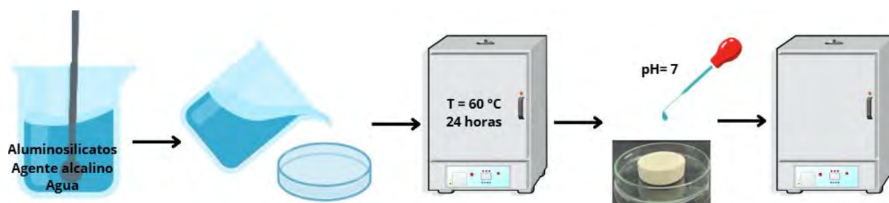
Figura 5: Proceso de elaboración de los geopolímeros.
