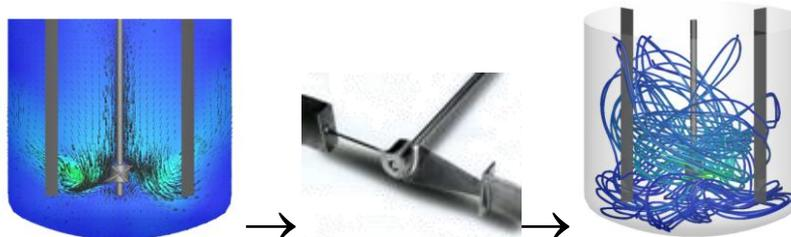
Figura 10. Perfiles y vectores de velocidad, geometría y líneas de trayectoria para un impulsor de flujo cruzado de dos aspas.
