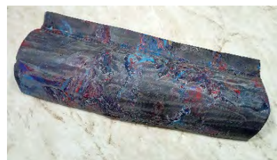
Figura 8. Teja fabricada de PP reciclado.
