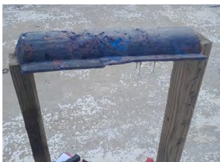
Figura 6. Sistema de estudio para radiación sobre la teja de PP reciclado.
